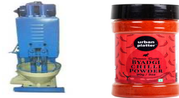
चित्र. 2.3. मिर्च पाउडर के उत्पादन के लिए हैमर मिल
