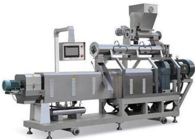
चित्र 8- ऑटोमैटिक कुरकुरे बनाने वाली मशीन।
