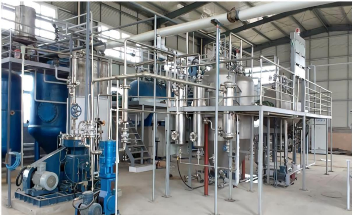
शिमला मिर्च लाल वर्णक एक्सट्रैक्शन मशीनरी (5 टन/दिन)
