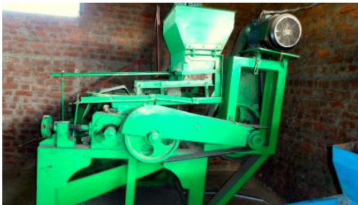
चित्र. 7 पतले परतदार चावल बनाने के लिए रोलर मशीन
